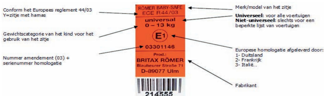
FIGUUR 2 : Gestandaardiseerd label waarop de homologatie-elementen van een KBS vermeld staan
